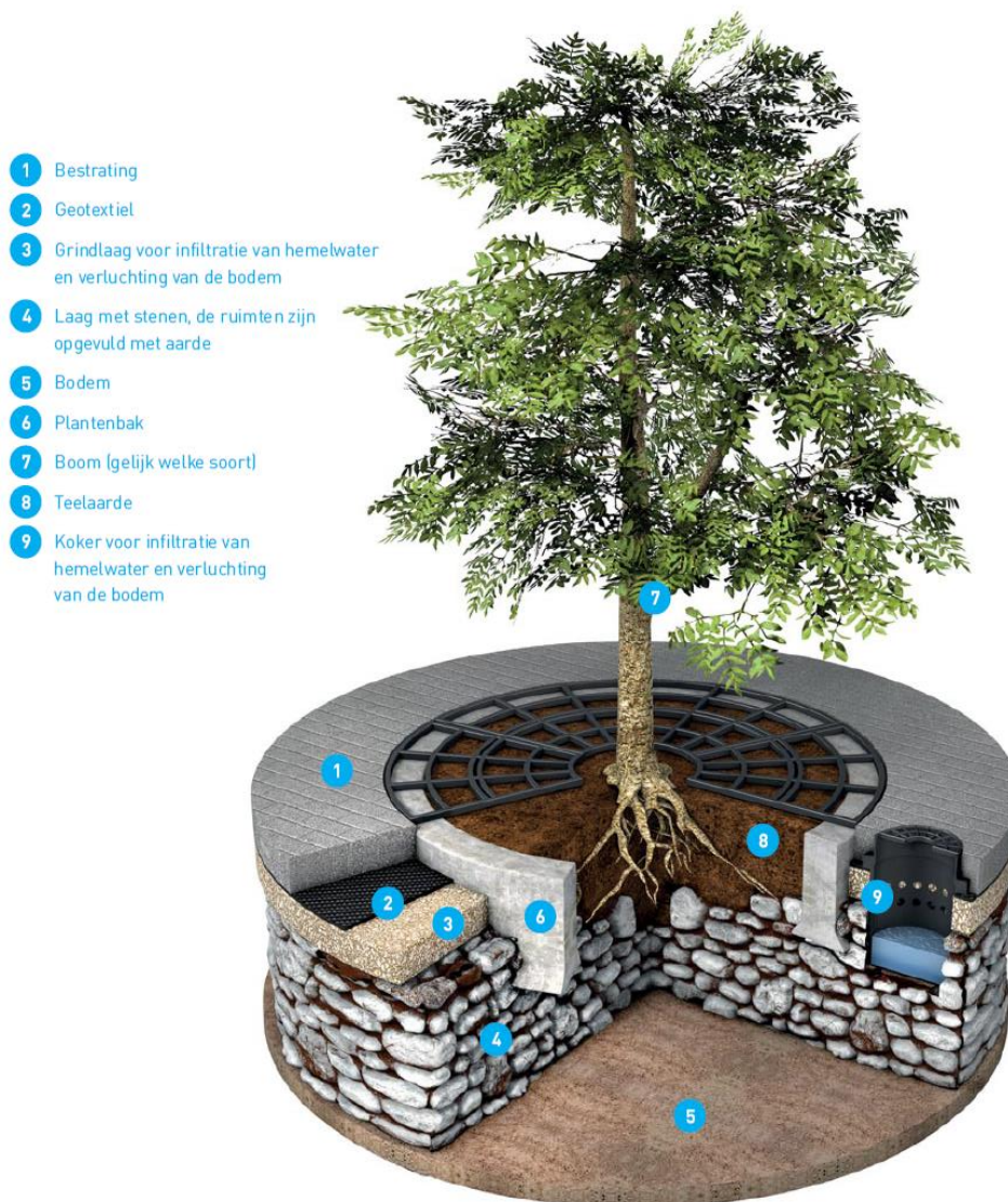
Figuur 28 Straatboom ontworpen volgens het Stockholm-principe.
