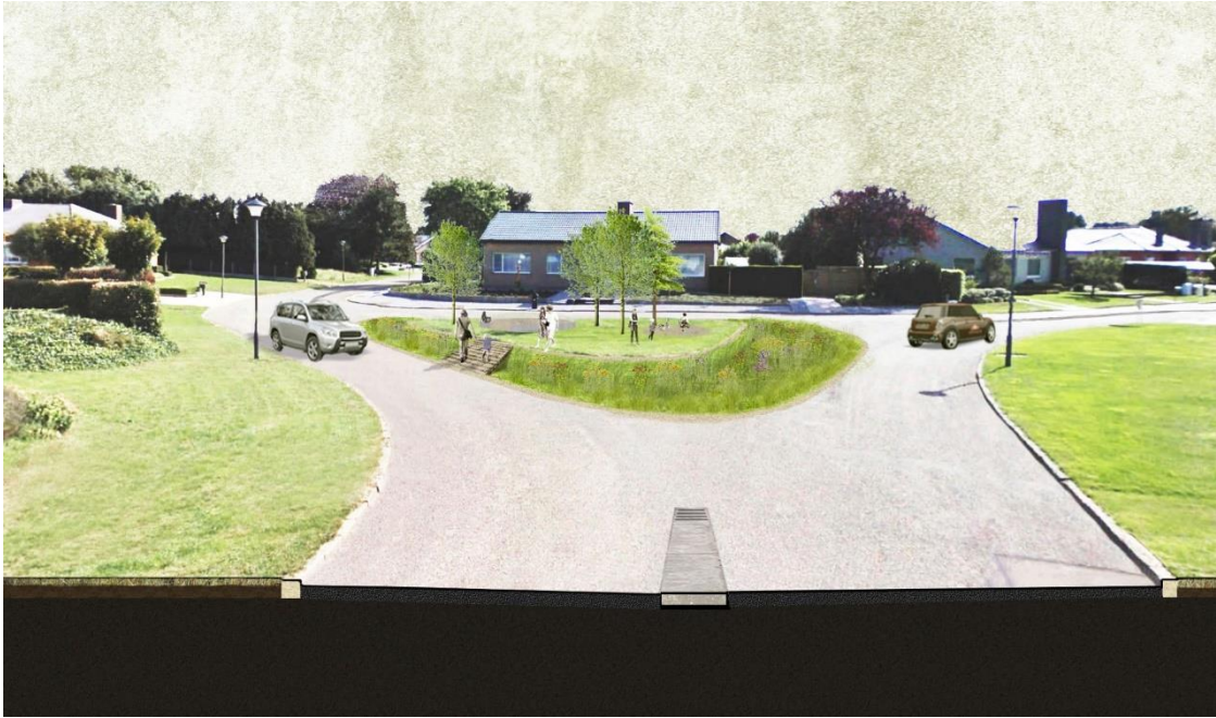
Figuur 8 Groenblauw netwerk met oppervlakkige hemelwaterafvoer en lokale bufferzones. De straatafvoer wordt opgevangen in wadi's langs de kant van de weg (boven) of in een centrale geul (onder). Op de kruispunten is er ruimte gemaakt voor waterbuffering.
