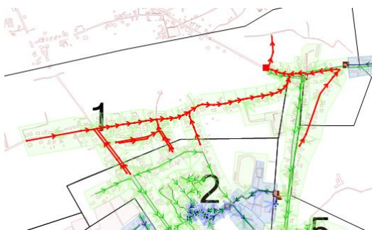
Figuur 4 Rioleringsleidingen opwaarts van overstort Vorsterweg.
