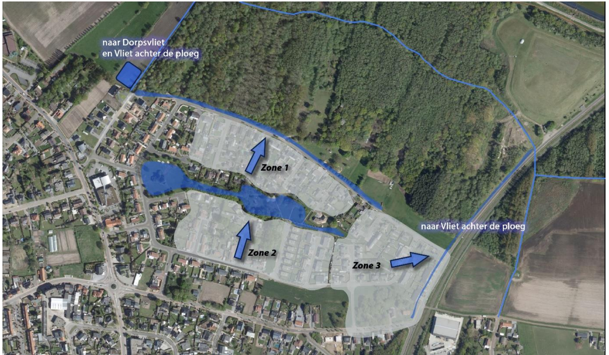
Figuur 10 Voorstel voor hemelwaterbuffering aan Begijnenwinning. Een wadi in het midden om zone 2 te bufferen, een gracht parallel aan de meest noordelijke straat voor de RWA van zone 1 en een gracht parallel aan de Spoorwegstraat voor zone 3.
